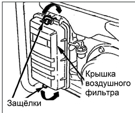
Рис. 13 Снятие крышки воздушного фильтра
