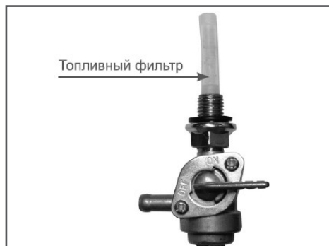
Рис. 16 Обслуживание топливного фильтра
