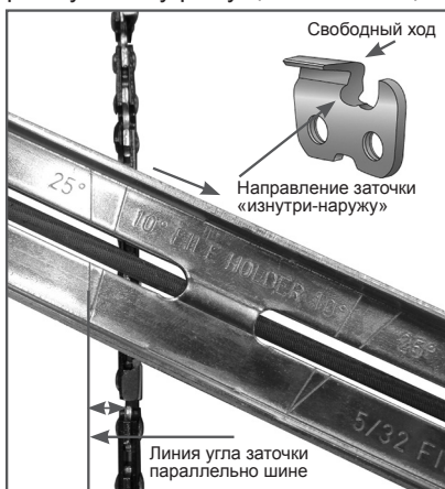
Рис. 18 Определение угла заточки
